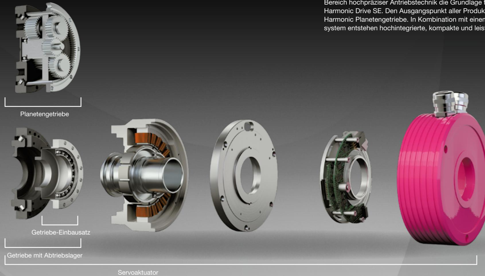
Die bewährten Komponenten Getriebe, Abtriebslager, Motor und Gebersystem bilden im Bereich hochpräziser Antriebstechnik die Grundlage für unterschiedliche Produktgruppen der Harmonic Drive SE. Den Ausgangspunkt aller Produkte bilden Harmonic Drive® Getriebe oder Harmonic Planetengetriebe. In Kombination mit einem Servomotor und einem Motorfeedbacksystem entstehen hochintegrierte, kompakte und leistungsstarke Servoaktuatoren.
