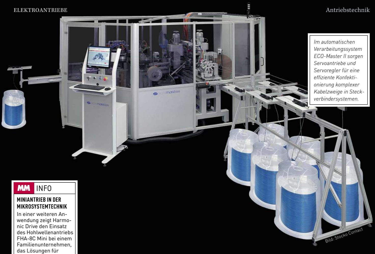
Im automatischen Verarbeitungssystem ECO-Master II sorgen Servoantriebe und Servoregler für eine effiziente Konfektionierung komplexer Kabelzweige in Steckverbindersystemen.
