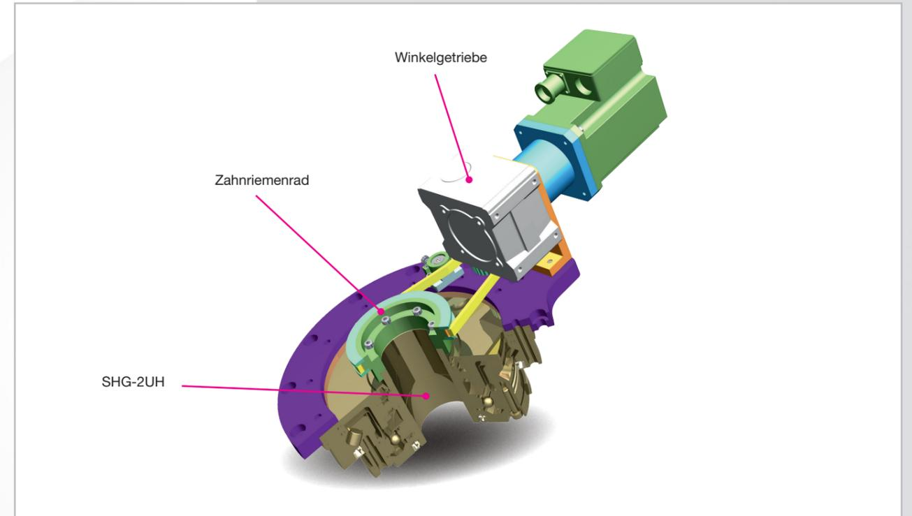
Getriebe für Robotikachse mit Sonderhohlwelle zur Anbindung der Rotormagnete, des Encoders sowie der Bremse
